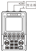
图 6 测量三线制变送器
